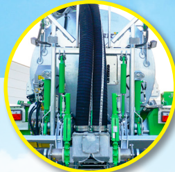
Anti-goteo hidráulico (sistema TWIST)
